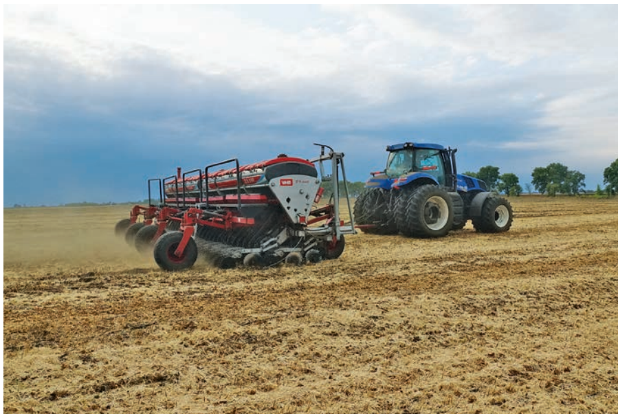
Сівба зернових відбувається за допомогою сівалки VNB з шириною захвату 10,6 м і кількістю рядків – 53
